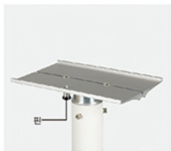
체결판 (슬라이드) 마운트 판은 좌우 삽입이 가능합니다. 핀으로 장비 부착판을 고정합니다. 마운트 판은 약간의 틸팅(각도조절)을 지원합니다.
