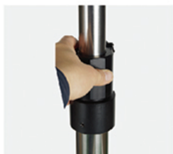
높낮이조절 브라켓 높이를 조절할 수 있는 모델의 경우, 손잡이 부분을 돌려주어 높이를 결정한 후 잠근 후에 옆에 부착된 볼트로 2차 고정할 수 있습니다.
